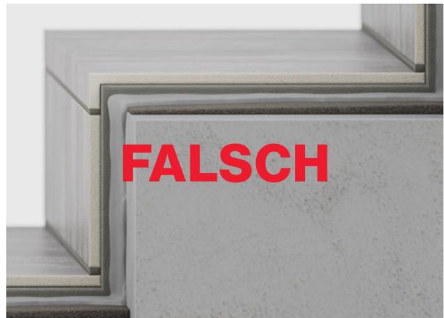
Für eine sichere Treppenkonstruktion ist die Stellstufe hinter die Stufen- bzw. Schenkelplatte mit einem Luftspalt von 3–4 mm zu verarbeiten und nicht miteinander zu vermörteln. Das Aufsetzen und Vermörteln der Stufenplatten mit der Stellstufe führt aus konstruktiven Gründen im Außenbereich zu Schäden.
